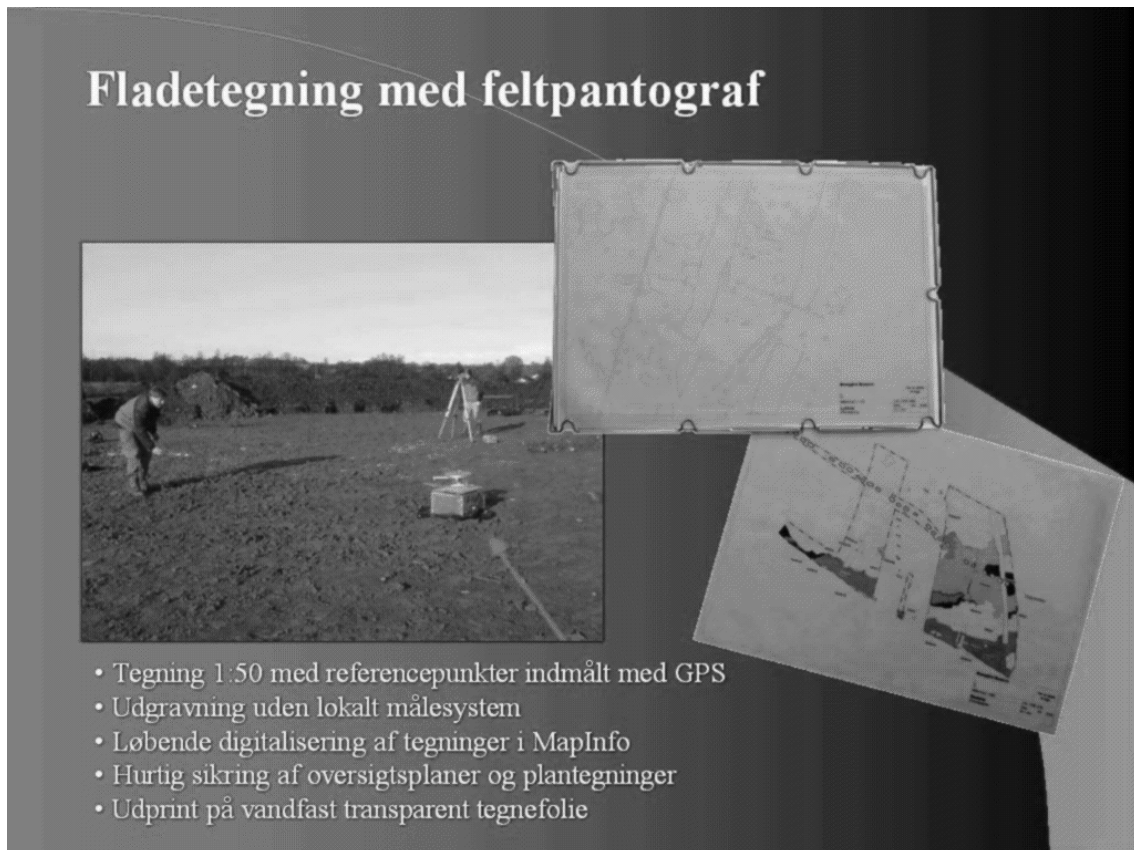
Fig. 1 Det ses her, hvordan man benytter en feltpantograf til opmåling og så efterfølgende scanner tegningen til videre bearbejdelse i MapInfo. (Niels H. Andersen 2002)
