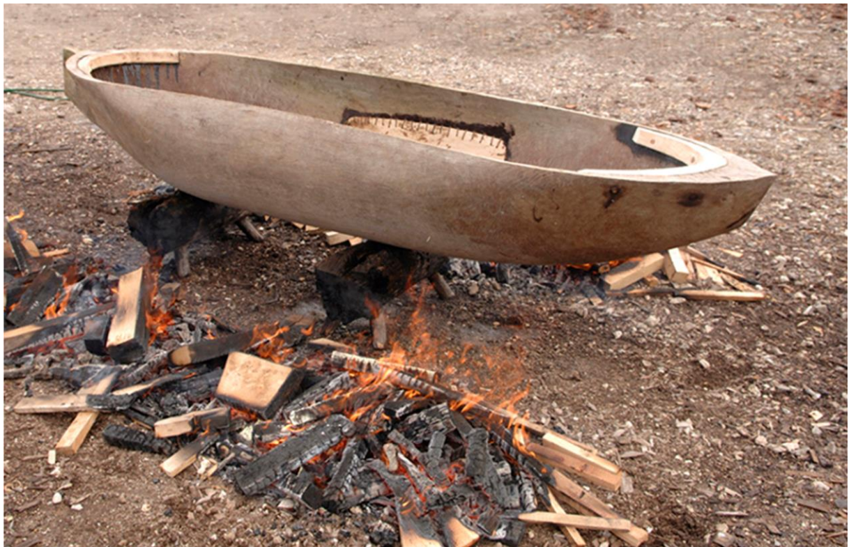
Fig. 2. Slusegårdsbåden varmes op før udspændingen. Foto Werner Karrasch, © Vikingeskibsmuseet i Roskilde.
