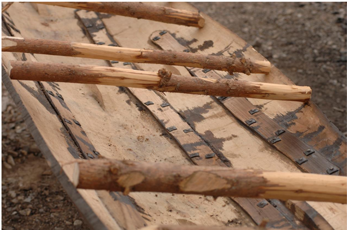
Fig. 4. Bjørkebådens udspændte bunddel. Der ses flere reparationslapper over sprækker, der opstod under udspændingen. Foto Werner Karrasch, © Vikingeskibsmuseet i Roskilde.
