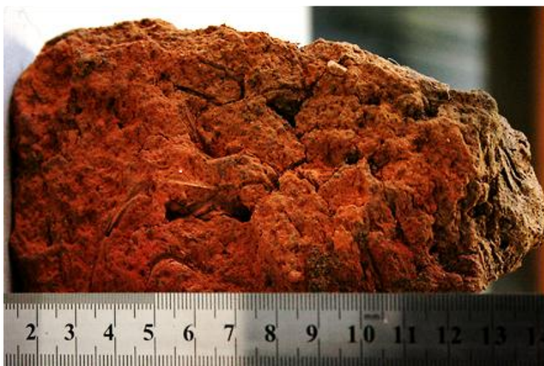
Fig.8: Skaktyderside med stråaftryk
