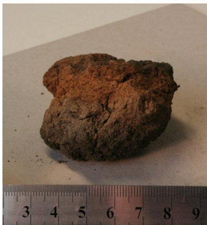
Fig.20: Meget porøst, sandholdigt ler
