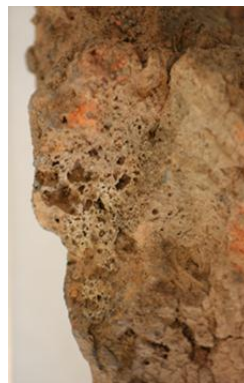
Fig.3: Nærbillede af sintret leret nær
